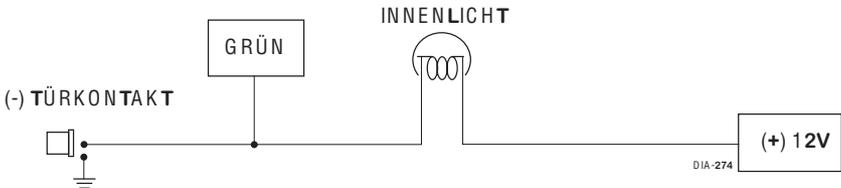
**WICHTIG!** Wenn das Fahrzeug über eine werksseitige Innenlichtausschaltverzögerung verfügt, kann es zu einer Fehlermeldung (zweiter Sirenenchirp nach dem Schärfen) kommen. Im Menü 2 der Betriebseinstellungen können Sie diese Fehlermeldung herausprogrammieren.
