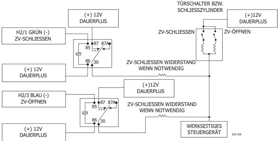
**EIN WIDERSTAND VERSION:** Wenn ein Widerstand integriert ist, ist ein Impuls mit einer Spannung von +12 Volt für die eine Richtung und einer mit einer Spannung kleiner als +12 Volt für die andere Richtung messbar.
