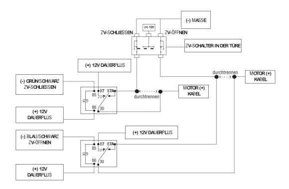
**WICHTIG!** Wenn die Leitungen nicht korrekt angeschlossen werden, können entweder die Alarmanlage oder der ZV-Schalter zerstört werden.
