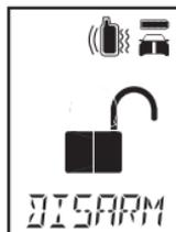
**Details:** Die Sirene im Fahrzeug wird zweimal chirpen und die Blinker zweimal blinken. Wenn eine Zentralverriegelung angeschlossen ist, werden die Türen geöffnet. Die 2-Wege Fernbedienung wird zweimal chirpen und das offene Symbol wird angezeigt um das Entschärfen zu bestätigen.
