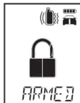
**Details:** Die Sirene im Fahrzeug wird einmal chirpen und die Blinker einmal blinken. Wenn eine Zentralverriegelung angeschlossen ist, werden die Türen verschlossen. Das System sucht beim schärfen automatisch nach Fehlern. Die 2-Wege Fernbedienung wird einmal piepsen und das geschlossen Symbol wird angezeigt um das Schärfen zu bestätigen. Wenn keine Bestätigung empfangen wird, wird die Fernbedienung eine Reichweiten Meldung anzeigen.
