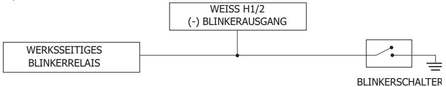
**WICHTIG!** Wenn die Blinkanlage des Fahrzeuges mehr als 10 Ampère Stromverbrauch hat, müssen Sie ein externes, optionales Relais vom Typ 610T verwenden. Dieses Relais kann mit 40 Ampère belastet werden.
