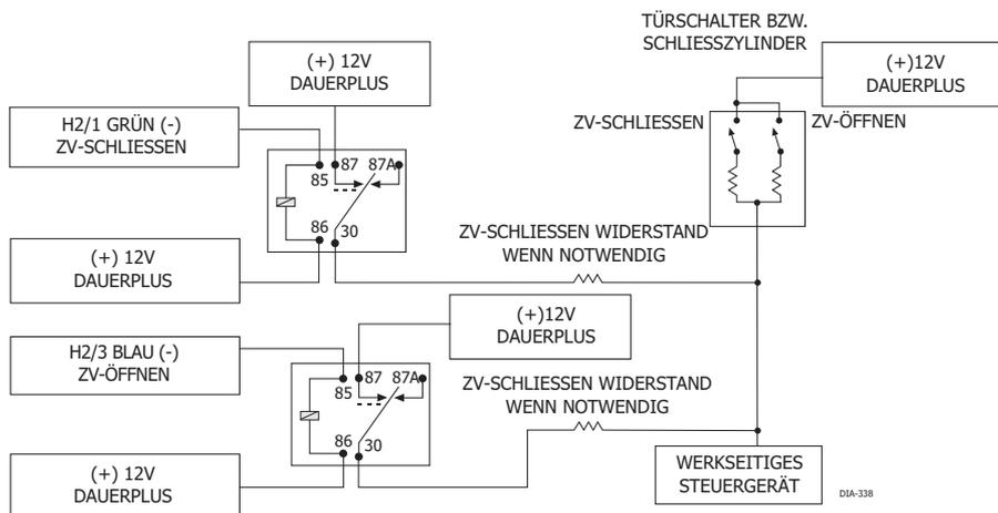
**EIN WIDERSTAND VERSION:** Wenn ein Widerstand integriert ist, ist ein Impuls mit einer Spannung von +12 Volt für die eine Richtung und einer mit einer Spannung kleiner als +12 Volt für die andere Richtung messbar.
