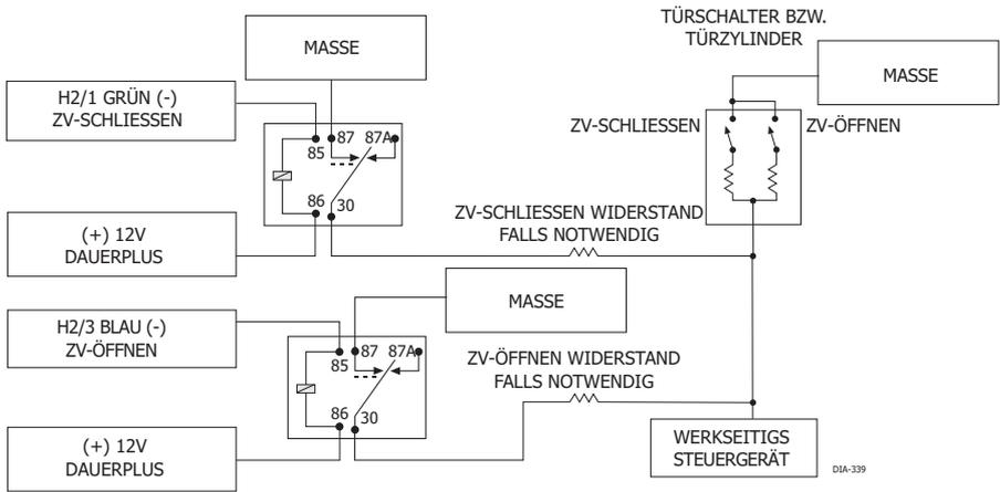
**EIN WIDERSTAND VERSION:** Wenn ein Widerstand integriert ist, ist ein Impuls mit Masse für die eine Richtung und einer Masse über einen Widerstand geführt in die andere Richtung messbar.
