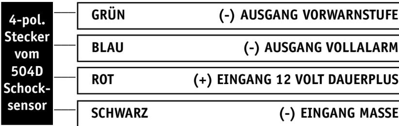
Wenn Sie den mitgelieferten 2-Zonen Schocksensor Typ 504D und den optional erhältlichen 2-Zonen Radarsensor Typ 508D gleichzeitig in einem Fahrzeug verwenden möchten, müssen Sie die beiden Alarmausgänge der Sensoren wie folgt verdrahten:
