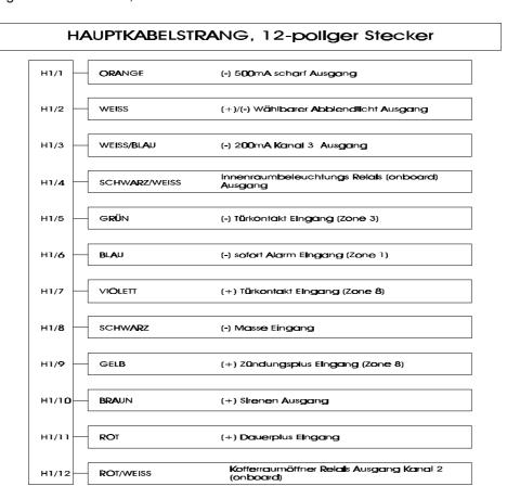
H 1/1 ORANGE (-) Masse Ausgang wenn scharf geschaltet: Dieser Draht gibt solange Masse, solange dir Alarmanlage scharf geschaltet ist. Sobald entschärft wird liegt an ORANGE keine (-)
