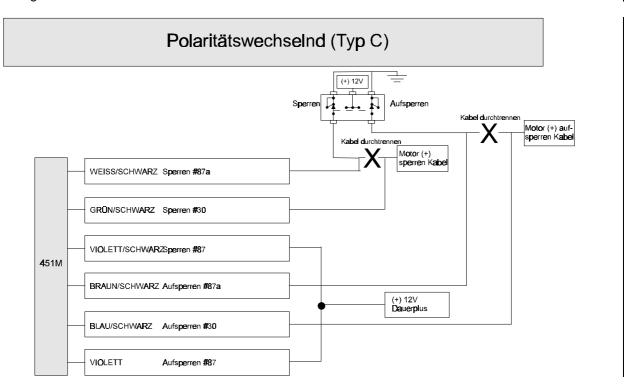
Verwenden Sie diese Anleitung, wenn vom Zentralverriegelungsschalter vier bis fünf starke Kabel wegführen. Bei diesem Typ liegen zwei Kabel auf (-) Masse.
