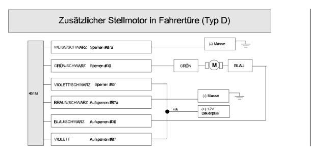
**Typ "E" Mercedes-Benz und Audi** (ab 1985): Zentralverriegelungssysteme mit elektrisch aktivierter Vacuumpumpe. Das Steuerkabel zeigt (+) 12V beim AUFSCHLIESSEN und (-) Masse beim SCHLIESSEN. **ACHTUNG**: Auch Golf III verfügen über ein Vacuumpumpensystem, sind aber nach Typ "A" anzuschließen. **WICHTIG**: Programmieren Sie die 600HF auf einen 3,5 Sekunden Zentralverriegelungsimpuls!
