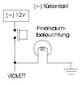
zustande, da die Alarmanlage, sobald die Innenraumbeleuchtung abgeschaltet wird, die Türen wieder in die Überwachung aufnimmt.
