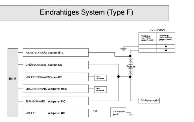
Dieses System erhält einen (-) Masse-Impuls zum AUFSCHLIESSEN, ein Unterbrechen dieses Kontaktes bewirkt das SCHLIESSEN (Bei einigen Fahrzeugen umgekehrt!).
