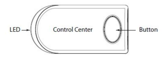
Das zentrale Kontrollcenter sendet und empfängt Befehle und Mitteilungen zum und vom System. Es befindet sich normalerweise im oberen Teil der Windschutzscheibe. Es besteht aus:
