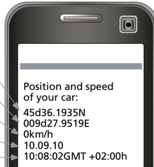
Im Fall der Einstellung der Funktion LINK auf den Wert 1 (Funktion ist AN), sendet der LOC200 Nachrichten mit GPS-Koordinaten in Form eines Links, um die Position des Fahrzeugs im Internet anzuzeigen.
