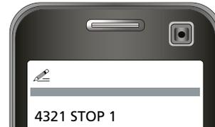
Das Kommando **STOP 1** schaltet das interne Relais für 240 Minuten wenn die Geschwindigkeit des Fahrzeugs 0 Km/h beträgt. Wird das Kommando empfangen während sich das Fahrzeug bewegt, schaltet es erst, wenn das Fahrzeug stoppt. Nachdem das Relais geschaltet hat, sendet die Zentrale eine SMS mit der exakten Position an der das Relais geschaltet hat. Wird das Kommando **STOP 1** mehrfach gesendet, kann die Zeit für die das Relais angezogen ist, verlängert werden.
