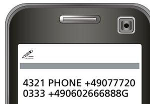
Parameter z ist optional. Ist diese Nummer ohne Parameter eingegeben, bedeutet dies, dass Nachrichten von beiden **INPUT** und GPS-Alarm an diese Nummer gesendet werden (der Wert IG ist automatisch eingestellt).
