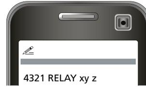
Der Parameter z ist optional. Wird der Befehl **RELAY** ohne Parameter z eingegeben, wird das Relais bei **INPUT** und **GPS**, Alarmaktivierung geschaltet.
