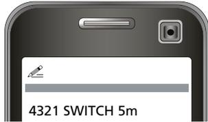
Die Schaltzeiten des Relais im LOC200 können durch den Befehl **SWITCH** inkl. der Parameter **xy** umgestellt werden, so dass bestimmte Geräte des Fahrzeuges (z.B. Standheizung) für eine begrenzte Zeit ferngesteuert EIN und AUS geschaltet werden können.
