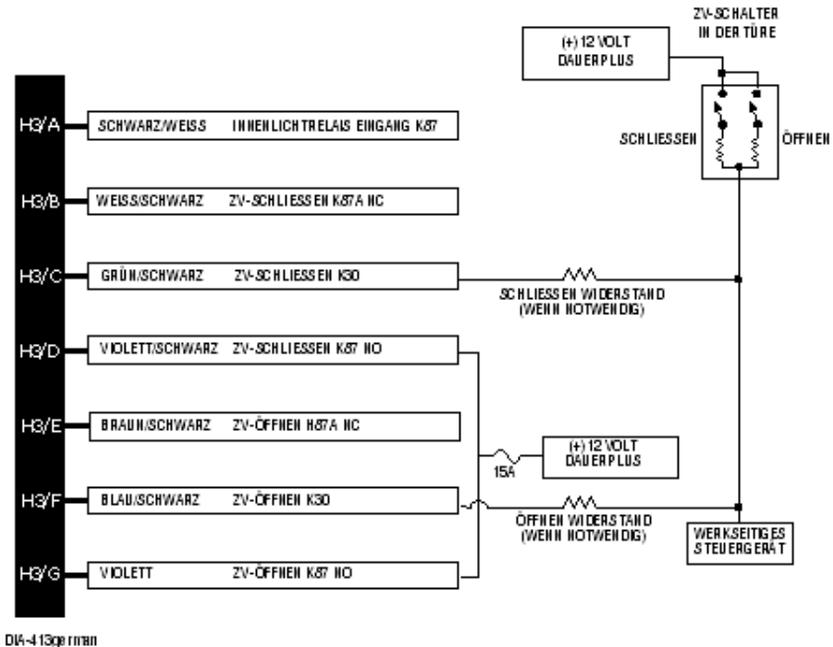
**EIN WIDERSTAND VERSION:** Wenn ein Widerstand integriert ist, ist ein Impuls mit einer Spannung von +12 Volt für die eine Richtung und einer mit einer Spannung kleiner als +12 Volt für die andere Richtung messbar.
