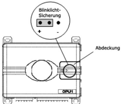
Mit der internen Steckbrücke (Sicherung/Jumper) können Sie die Polarität des Blinkimpulses ändern. In der (+) Position liefert das eingebaute Relais auf dem weißen Kabel (H1/2) eine Spannung von +12 Volt mit einer Belastbarkeit von 10 Ampere. In der (-) Position liefert das Relais auf dem weißen Kabel (H1/2) (-)Masse mit einer Belastbarkeit von 10 Ampere. Um Zugriff zu dem Jumper zu bekommen, entfernen Sie die Abdeckung an der Oberseite der Zentrale.
