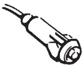
**Im Lieferumfang des Transpondermoduls ist eine rote LED enthalten. Diese kann zur Funktionskontrolle an den 2-poligen Stecker am Transpondermodul angeschlossen werden. Sie leuchtet im entschärften und erlischt im geschärften Zustand. Diese LED ist NICHT fix zu installieren!**
