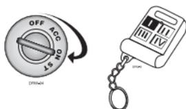
Solange das System noch keinen VRS-Vollalarm ausgelöst hat, können Sie das VRS entschärfen durch Einschalten der Zündung und Taste 1 für eine Sekunde gedrückt halten. Die Fahrzeugblinker blinken und die Sirene chirpt 2x zur Bestätigung. Das VRS ist entschärft.
