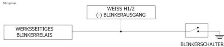
**WICHTIG!** Wenn die Blinkeranlage des Fahrzeuges mehr als 10 Ampere Stromverbrauch hat, müssen Sie ein externes, optionales Relais vom Typ 610T verwenden. Dieses Relais kann mit 40 Ampere belastet werden
