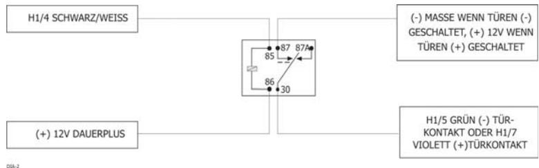
**H1/5 GRÜN (-) Türkontakteingang:** Die meisten Fahrzeuge haben negativ gesteuerte Türkontakte. Verbinden Sie das grüne Kabel mit einem Stromkreis, der bei geöffneter Türe (-)Masse führt. In Fahrzeugen mit werksseitiger Innenlichtverzögerung muss ein Kabel angeschlossen werden, das von der Verzögerung unbeeinflusst ist, oder das System muss entsprechend programmiert werden.
