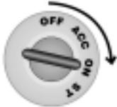
2. **Schalten Sie die Zündung ein und wieder aus.** (Das gelbe Kabel H1/9 muss angeschlossen sein.)
