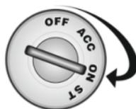
Um die optionale Startsperrung zu deaktivieren, schalten Sie die Zündung ein und drücken Sie innerhalb von 10 Sekunden einmal kurz den Service Taster. Die LED geht aus und das Fahrzeug lässt sich starten. Falls das Fahrzeug nicht startet, haben Sie zulange gewartet. Schalten Sie die Zündung aus und wiederholen Sie die Prozedur.
