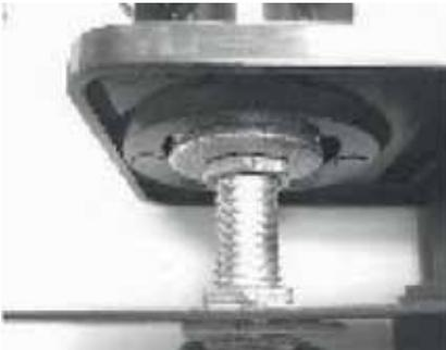
Muttern/Unterlegscheiben zwischen L-Halterung und Radioblende
