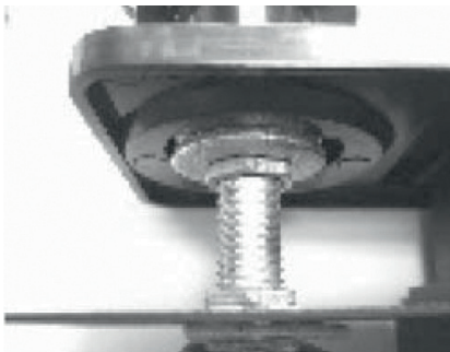
Muttern/Unterlegscheiben zwischen L-Halterung und Radioblende
