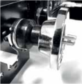
Abbildung 5 - Montage der Sichtkappe (optional)
