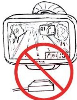
Befestigen Sie die GPS-Antenne (z. B. doppelseitiges Klebeband), um sicherzustellen, dass sie ihre Position während des Betriebs nicht ändert.
