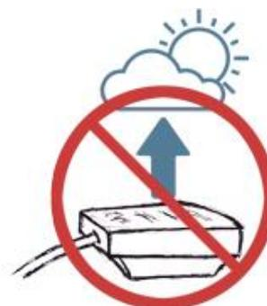
GPS-Antenne sollte nicht unter oder in unmittelbarer Nähe zu den massiven Metallstrukturen oder in der Nähe von anderen GPS-Geräten und Antennen platziert werden.
