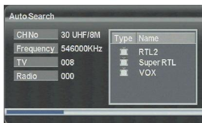
Drücken Sie die **MENU** Taste der Fernbedienung, um das Hauptmenü aufzurufen. Drücken Sie **6 0 5** um in die "Werkseinstellungen" zu gelangen. Benutzen Sie die **↑ ↓** Tasten um einen Punkt auszuwählen, z.B. die Antennenspannung, und die **← →** Tasten um den Wert zu ändern. Wählen Sie "Exit" und bestätigen Sie mit **OK** um die "Werkseinstellungen" zu verlassen.
