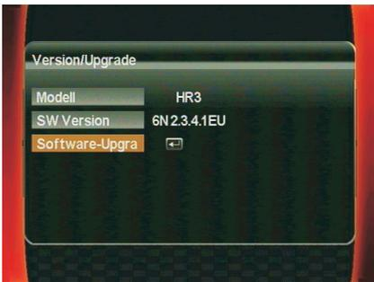
Zeigt den aktuellen Software-Stand an. Ein Software Upgrade lässt sich mittels 4-PIN Buchse auf der Geräteunterseite vornehmen.
